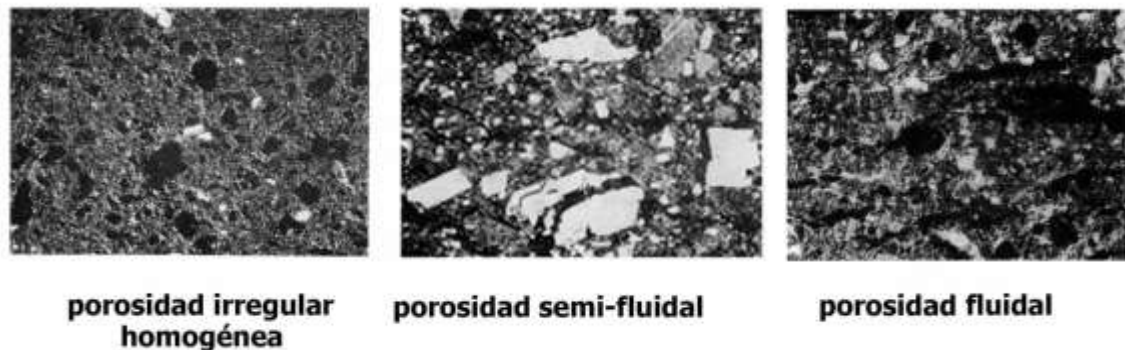
Figura 6.19.- Tres clases de porosidades de acuerdo a Ortega. Irregular homogénea (5x). Semifluidal (5X). Fluidal (5X). Los poros son en color gris oscuro o negro y las partículas en gris claro (1990).
